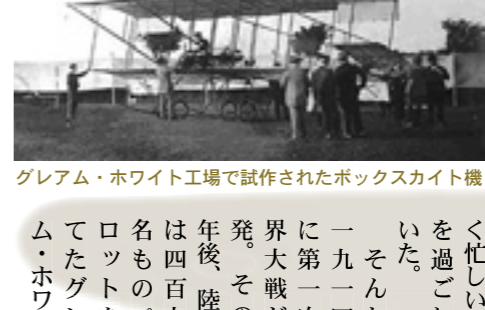
グレアム・ホワイト工場で試作されたボックスカイト機
